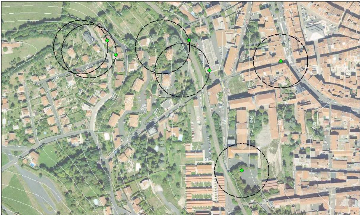
**Figure 29** : Exemple de localisation des zones d'incertitude (pointillés) des cavités / puits (points verts) dont l'extension est inconnue sur la commune du PUY-EN-VELAY (Haute-Loire) [Source : IMS<sup>RV</sup>]
